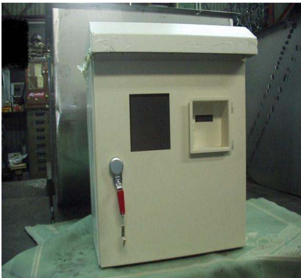
照明点灯盤（横600×縦730×奥行350）（材料：鉄／板厚：2.3t）
